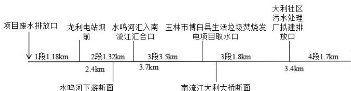
图 4.3-1 预测河段分段示意图
